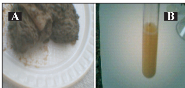
Fig. 4 - Lodo Sólido (A) antes do teste para análise qualitativa do cromo e (B) Cor Amarelada Indicando resultado positivo do teste (presença do metal)
